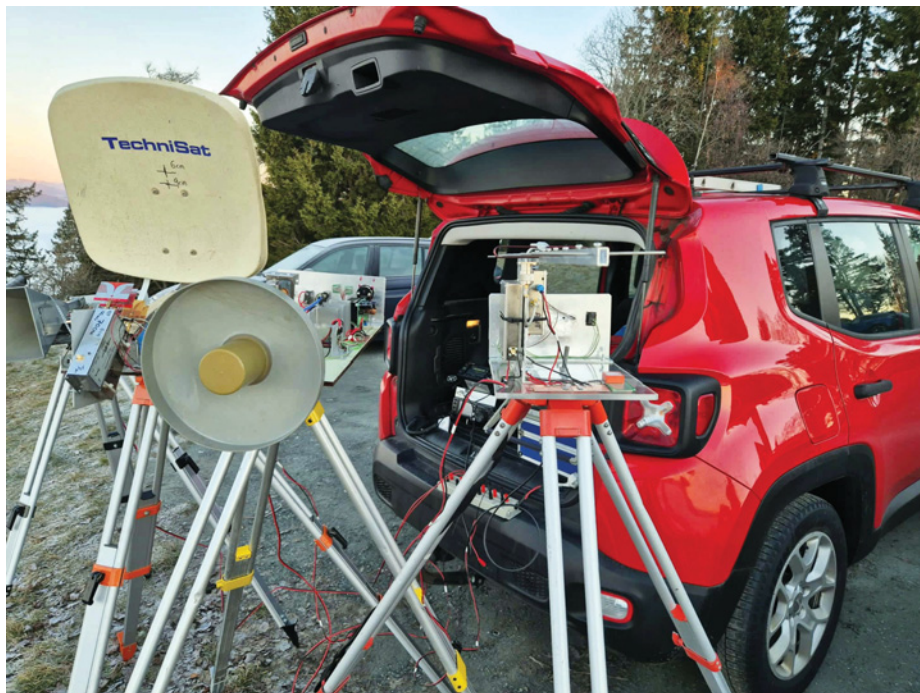
Ein paar der „Maschinen“ von OE8EGK – von links nach rechts: 24 GHz (Horn), 9 cm + 6 cm mit Spiegel, 13 cm, 23 cm mit Yagi.
