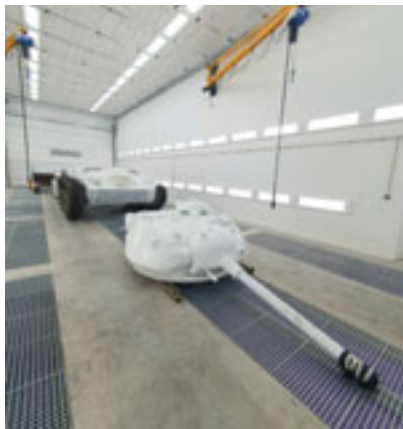
Lackier- und Trockenanlage mit Kampfpanzer M24
