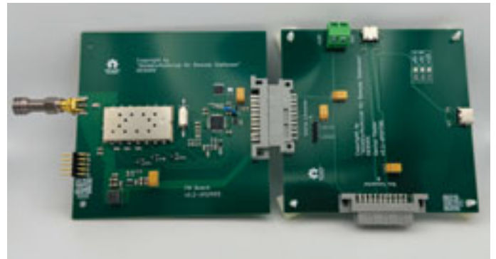
Das FMTransceiver-Modul wird über das DeviceTester-Modul programmiert und getestet.
