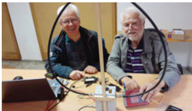
Willi OE3IDS und Franz OE3FFC beim Abgleich der SSB-Funktion des QMX
