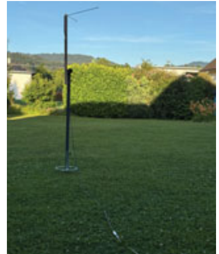
V-Dipol für 137MHz nach Adam 9A4QV
