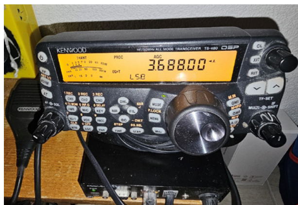
rechts: Bedienteil Kenwood TS480 mit Remote-Box in der Ferne, wo sich Michi aufhält
