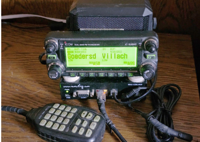
Bedienteil ICOM IC-2820 mit Remote-Box in der Ferne, wo sich Michi aufhält
