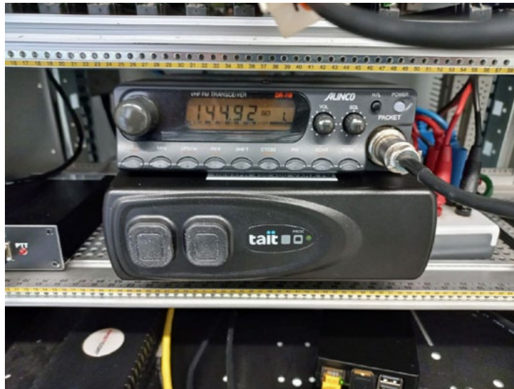
Funkgeräte im Rack: oben: Alinco, Mitte: Tait, unten: Raspberry Pi für Packet Radio Foto: Werner OE9FWV
