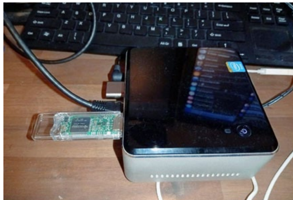
Der Mini-PC, auf dem der neue XLX905 läuft – hier während dem Testen. Der durchsichtige USB-Stick ist ein AMBE-Stick, der zum Konvertieren verwendet wird.
