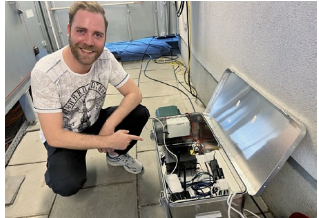
Markus OE6DVM mit der im Transportkoffer eingebaute 2m/70cm-Remotestation.
