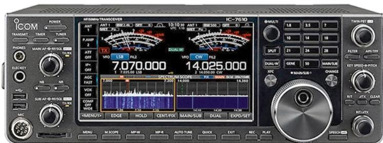
SDR-Transceiver mit zwei Direktabtast- Empfängern und eingebauten Antennentuner mit einen Anpassbereich von 16,7 bis 150  $\Omega$  (KW/6m).
