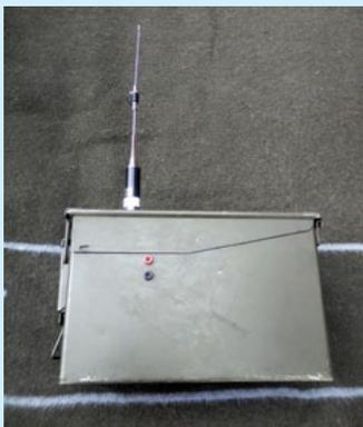
Antennen- und Ladebuchsen sind mit Silicon wasserdicht gemacht
