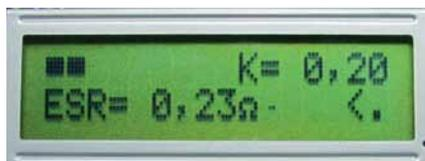
Links oben: Graphische Anzeige mittels Balkendiagramm (8 Balken). Die Anzeige ist logarithmisch (angenähert), dadurch können sowohl kleine als auch große Werte mittels eines Balkens gut dargestellt werden.
