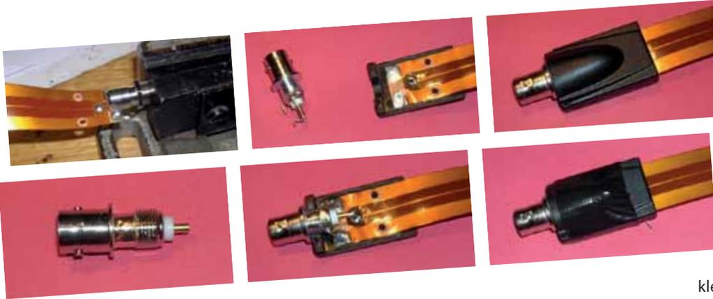
indem das Gewinde hinter dem Flansch mit der Schmalseite der Feile bis auf einen Durchmesser von 8 mm abgefeilt wird. Falls das Gewinde der BNC-Buchse nicht ohnehin schon eine Abflachung hat (es gibt da unterschiedliche Fabrikate), muss man eine Abflachung kabelseitig mit der Feile herstellen, so wie sie auch bei der originalen F-Buchse vorhanden ist.
