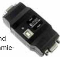
Er besitzt zwei serielle Schnittstellen, kann die Daten einer Wetterstation übertragen und verfügt bereits über einen internen Temperatursensor. Die Versorgungsspannung und Temperatur kann als Telemetriedaten ausgesendet werden.
