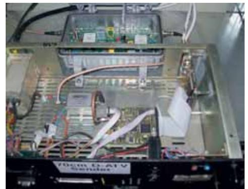
Draufsicht auf den 19 Zoll Einschub mit SR Steuersender und dahinter der Linearverstärker
