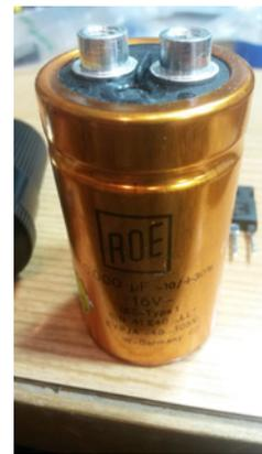
Bild 5 rechts: 10mF-Kondensator mit 16V Spannungsfestigkeit
