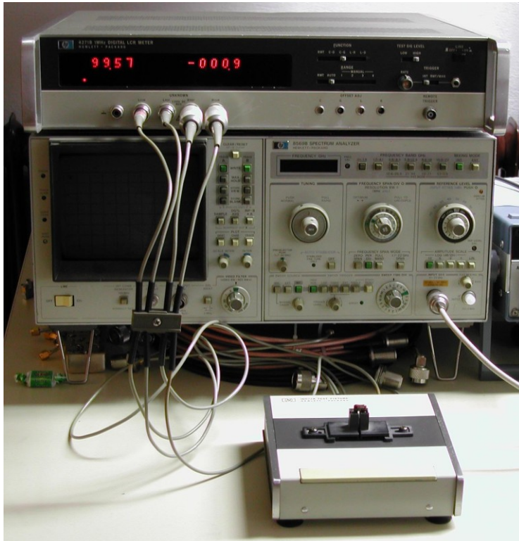
Abb. 13: Ermittlung von Referenzkondensatoren mit dem LCR-Meter HP 4271B
