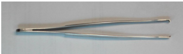
Abb. 2: Pinzette zum Aushebeln von DIL-ICs
